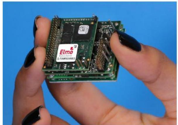
图 5：超小型高功率伺服驱动器：80A 80V
